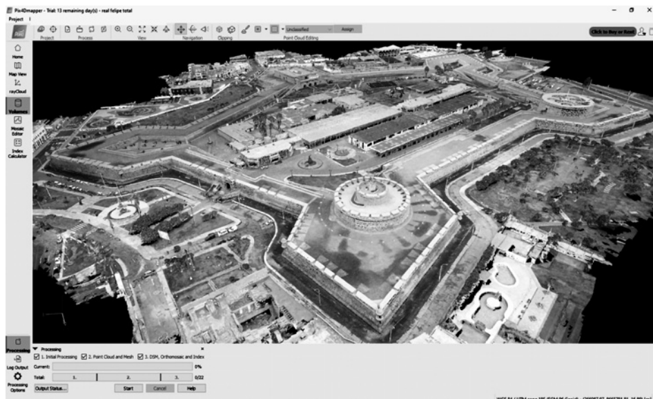
Figura 5: Procesamiento fotogramétrico (SFM) y generación del modelo digital de la Fortaleza del Real Felipe
